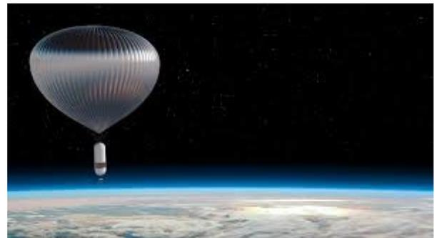
*Figure 36 : Exemple de ballon stratosphérique, pouvant s'élever à 25 km d'altitude.*
