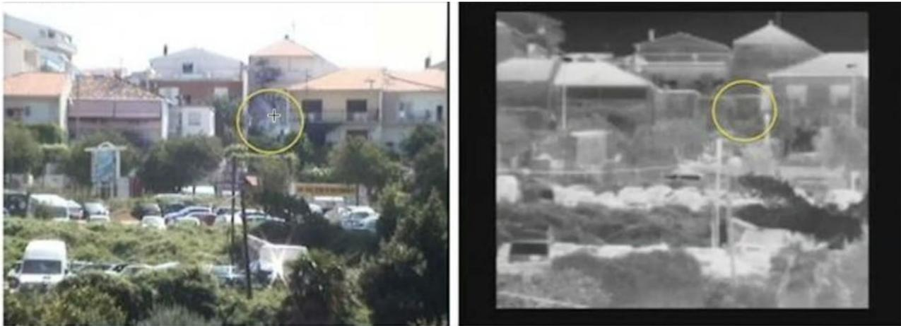
Figure 23 : Fumée détectée dans le spectre visible (à gauche), non détectée dans l'infrarouge (à droite) (source : D. Stipaničev).
