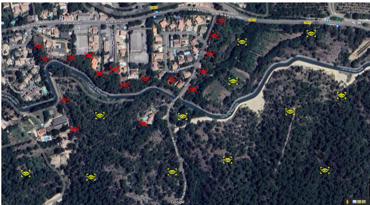
Figure 34 : Capteurs IoT en interface pour détection départs de feu - Capteurs IoT en déploiement large pour le mode suivi.
